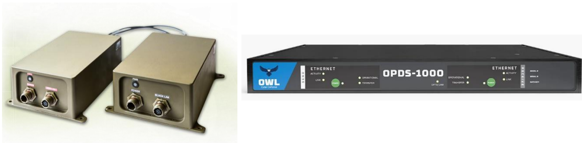
Obrázek 3.1 Dva typy datových diod, přičemž pravá varianta umožňuje podporu protokolů vyžadujících zpětnou odezvu.
