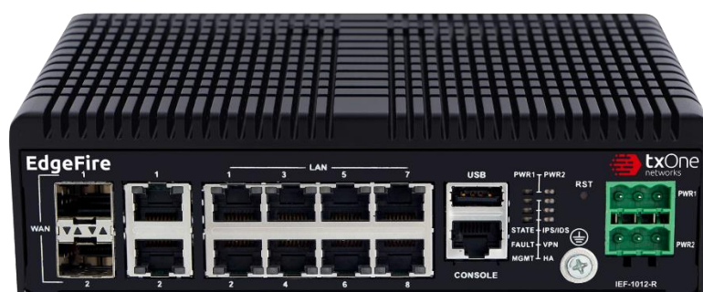
Obrázek 3.2: Průmyslový firewall EdgeFire od společnosti TXOne Networks. [15]
